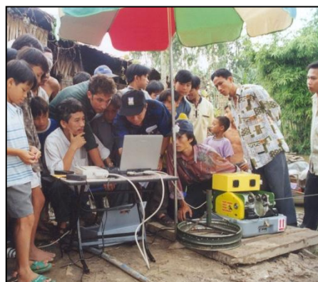
Hình 7. Trạm MGX-II đang thực hiện đo carota giếng khoan tại xã Thốt Nốt, thành phố Cần Thơ. Trạm đo được điều khiển và quan sát trên máy tính.
